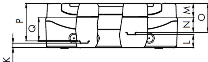
Q et N : distance entre le profilé et le plastron modulaire
